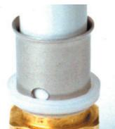
С помощью специального инструмента для опрессовки необходимо опрессовать фитинг подготовленного соединения. При этом труба должна быть свободна от напряжений. Выступ пластикового кольца должен располагаться в канавке прессколотки. Процесс опрессовки считается окончанным, если достигнуто полное закрытие прессовых колодок.
