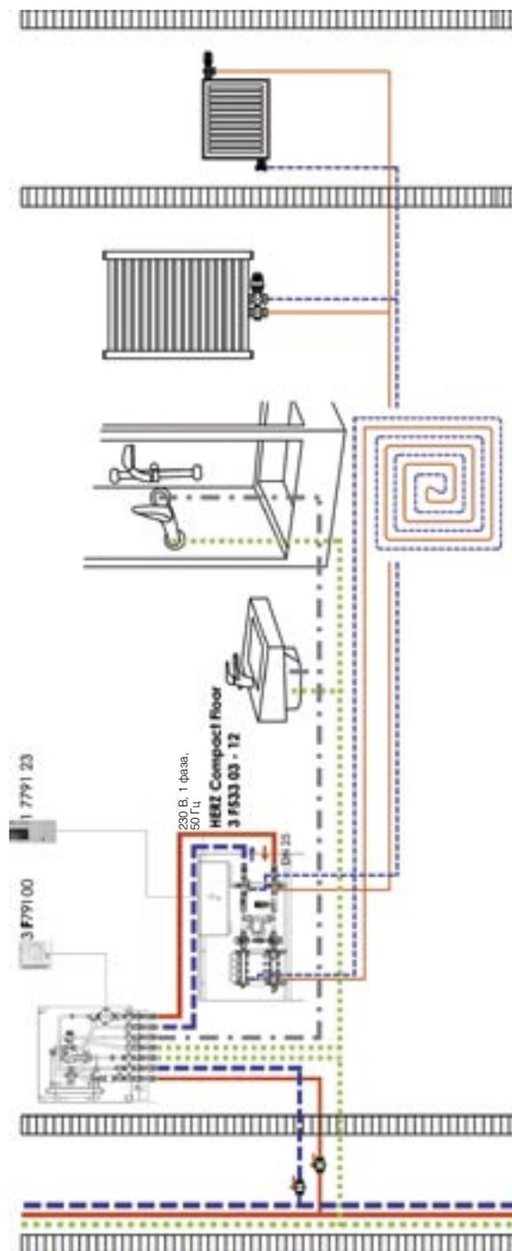
*Исполнение 3 F533 от 03 до 12 контуров, с распределителем для контура радиаторного отопления, для одновременной работы радиаторов, системы напольного отопления и контура горячего водоснабжения*
