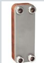
DW означает «Двойная стенка» (Double wall) – данная конструкция служит для минимизации рисков смешения контуров теплообменника. Благодаря двойной стенке оба контура герметично разделены друг от друга. Рабочие давления могут достигать 45 бар.
