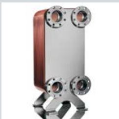
Теплообменники серии GK – аппараты с самыми высокими коэффициентами теплопередачи благодаря абсолютно новой геометрии пластин, использующих систему впадин и выпукостей, создающих локальные завихрения для улучшения теплообмена.
