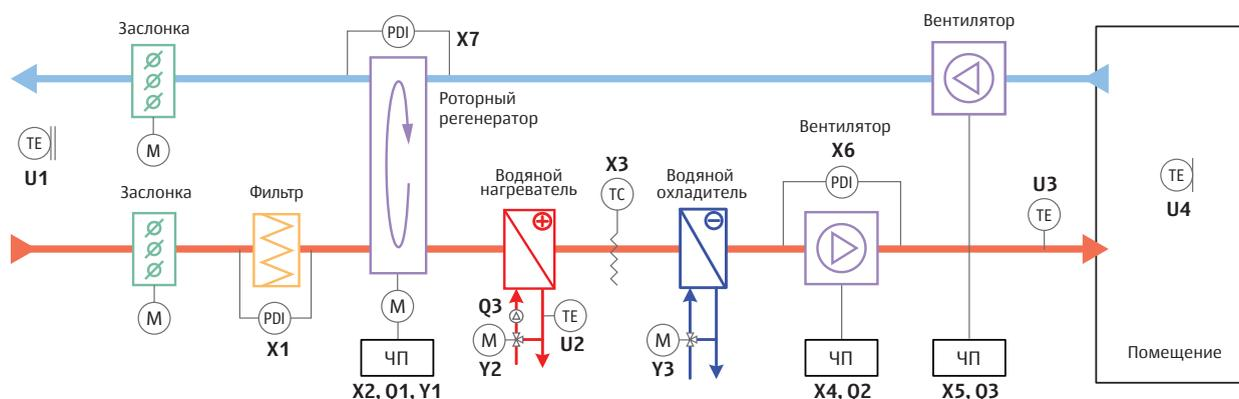
**Условные обозначения:** М — привод; PDI — дифференциальное реле давления; TE — датчик температуры; ЧП — частотный преобразователь; ККБ — компрессорно-конденсаторный блок.
