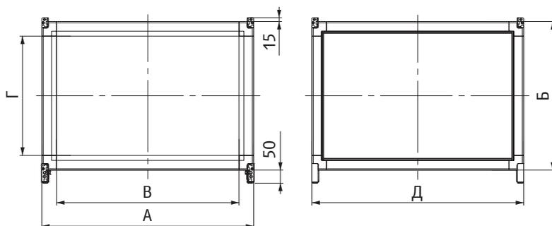
> Секции смешения двух типов: подмес воздуха сверху или снизу (SV) и подмес воздуха сбоку (SB).
