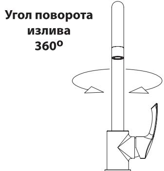
Аэратор (регулятор расхода воды) позволяет смесителю «выдавать» ровную водную струю без разбрзгивания.
