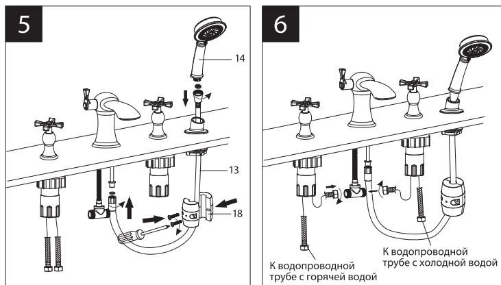
**7) Шланги для воды, вкрученные в рукоятки со сторон с обозначением стрелок «вверх» (см. пункт 2), присоедините к водопроводным трубам, руководствуясь принципом: левая рукоятка отвечает за регулировку горячей воды, а правая – холодной.**
