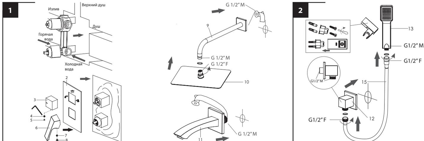
1. Подготовьте в стене каналы для размещения в них узлов встраиваемого смесителя и соединительной арматуры (в комплект не входит). Габариты посадочного места в стене для установки корпуса смесителя должны быть 80 мм в длину и 160 мм в высоту. Для удобства установки глубина посадочного места для размещения корпуса смесителя должна быть не менее 50 мм и не более 75 мм от внешней облицовки;
