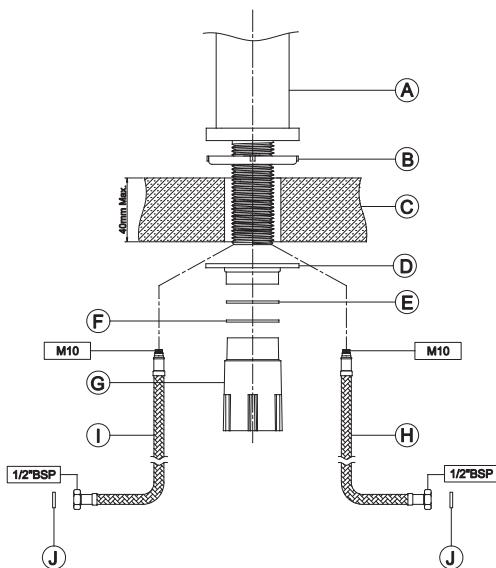
1. Для установки смесителя на рабочей поверхности/мойке (C) необходимо наличие сквозного отверстия диаметром 35 мм.
