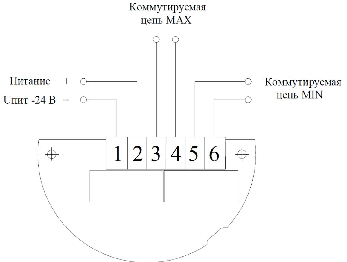
Рисунок В.1 Схема внешних электрических соединений.
