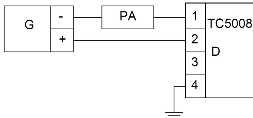
G-источник питания; D- датчик; PA-миллиамперметр
