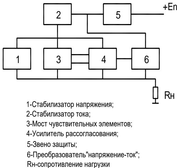
Рисунок Б.1 - Датчик с выходным сигналом от 4 до 20 мА
