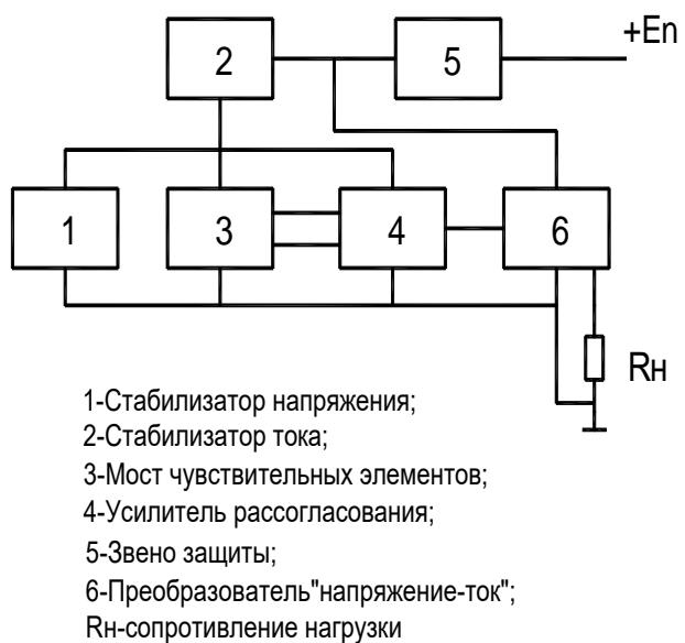
Рисунок Б.2 - Датчик с выходным сигналом от 0 до 5 мА
