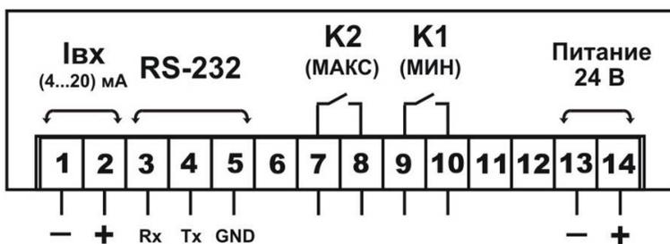
Рисунок Г.4 – Расположение выводов клеммной колодки прибора ЦИ5003Б/2
