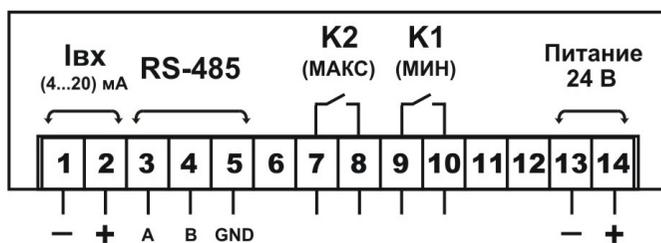
Рисунок Г.5 – Расположение выводов клеммной колодки прибора ЦИ5003Б/2
