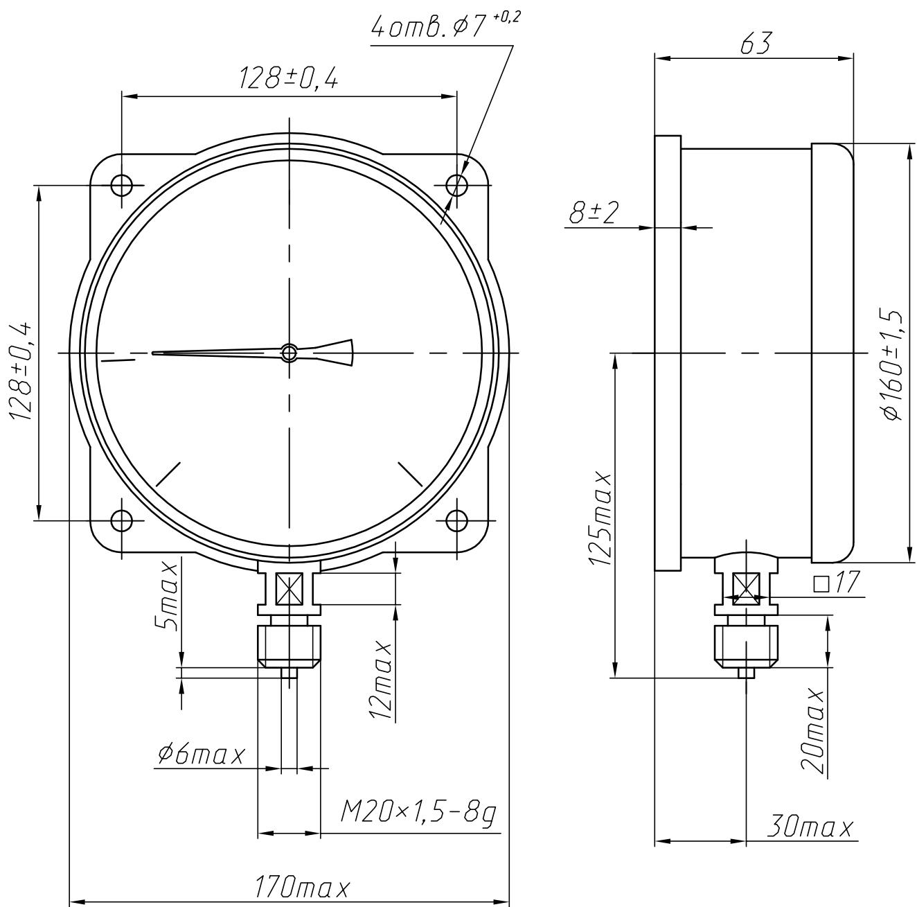
Рисунок 2 - Габаритные и присоединительные размеры мановакуумметра МВП4-СМ-Т
