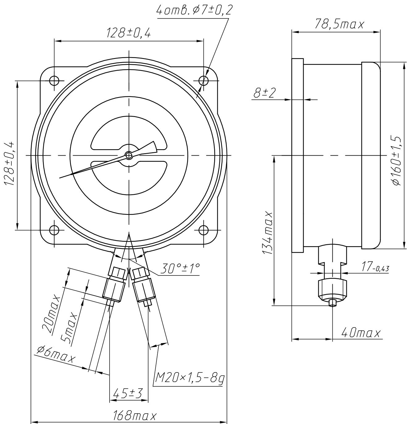
Рисунок 1 – Габаритные и присоединительные размеры манометра МДП4-СМ-Т
