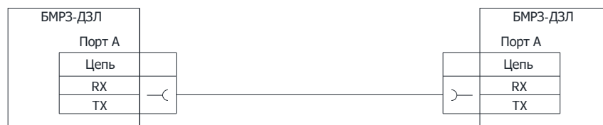
б) Подключение с применением Bidirectional SFP (таблица Д.2)
