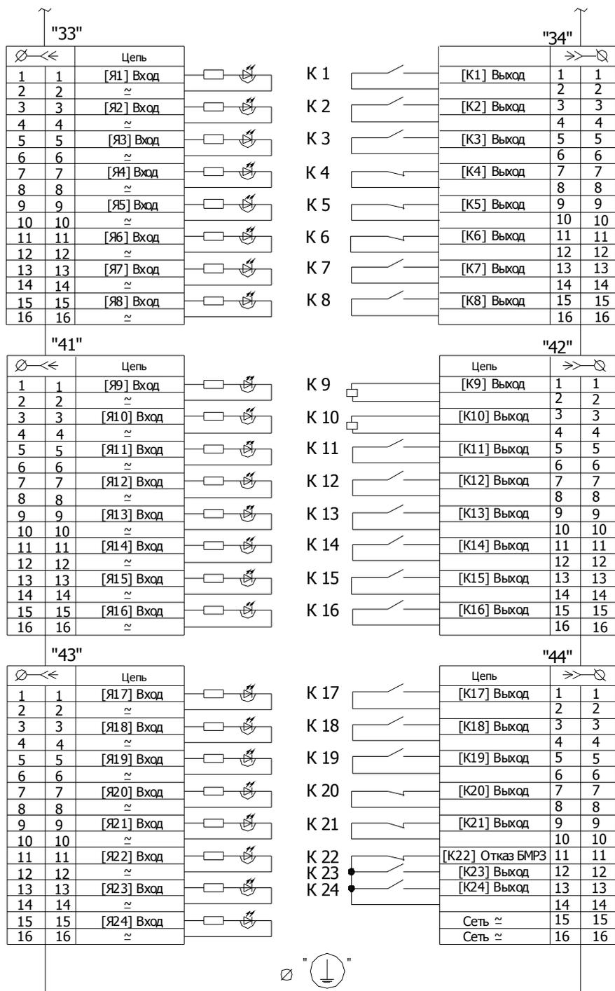
Рисунок А.1 (лист 2 из 2) - Схема электрическая подключения
