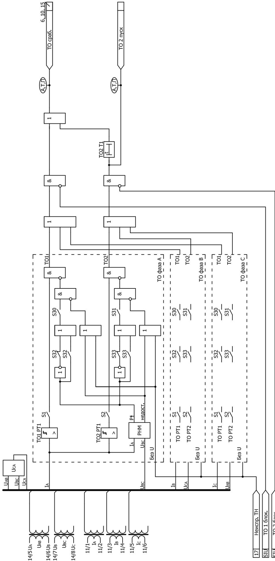
Рисунок Б.1 - Функциональная схема алгоритма токовой отсечки
