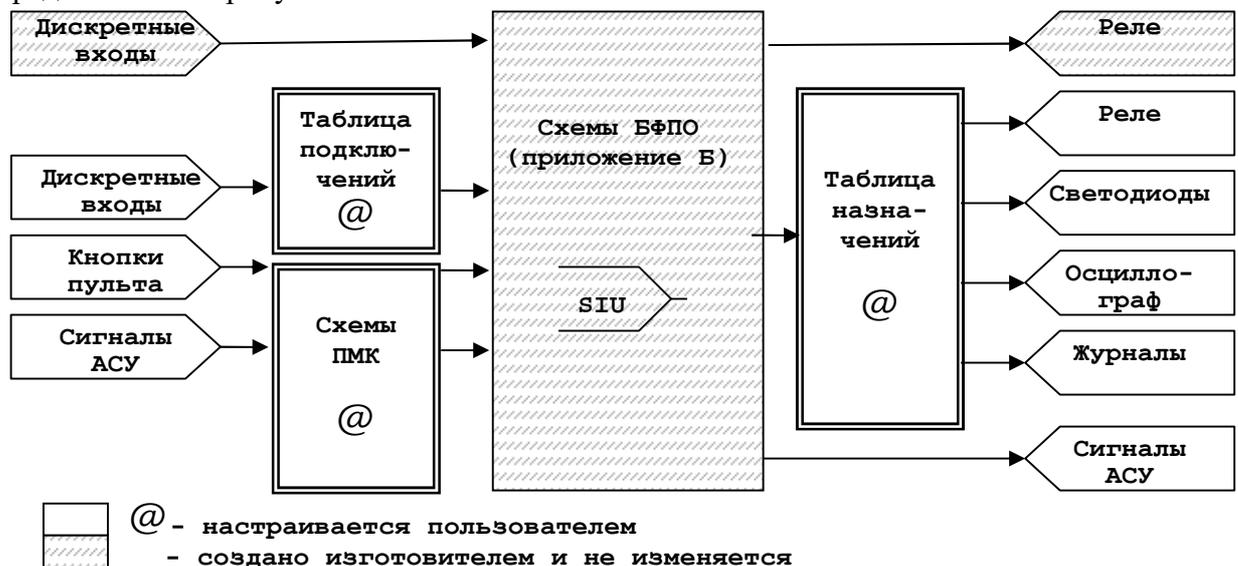
Рисунок 1 - Схема настройки блока
