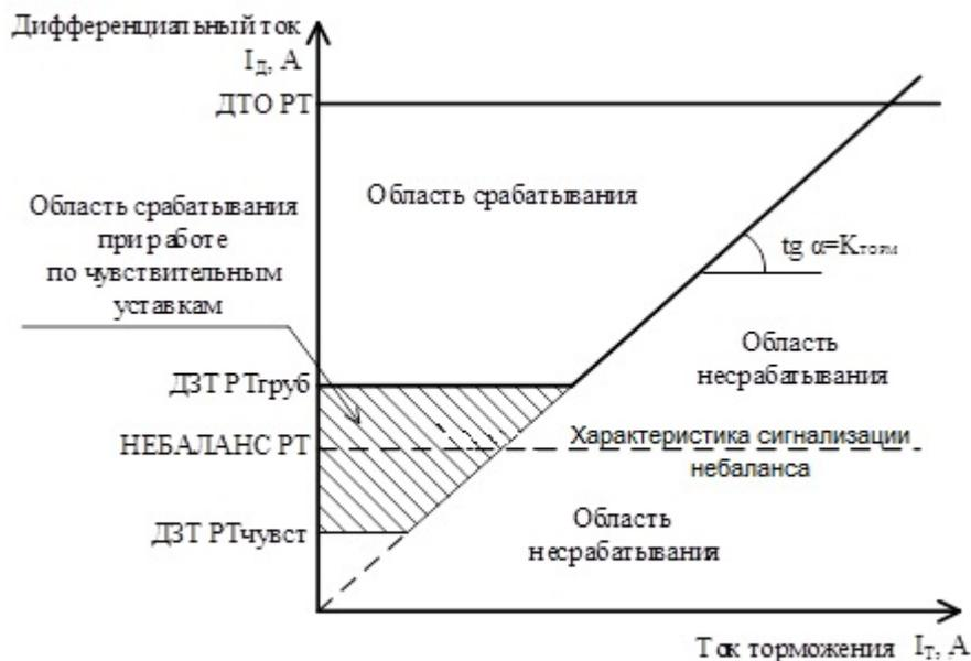
Рисунок 5 - Характеристика срабатывания дифференциальных защит
