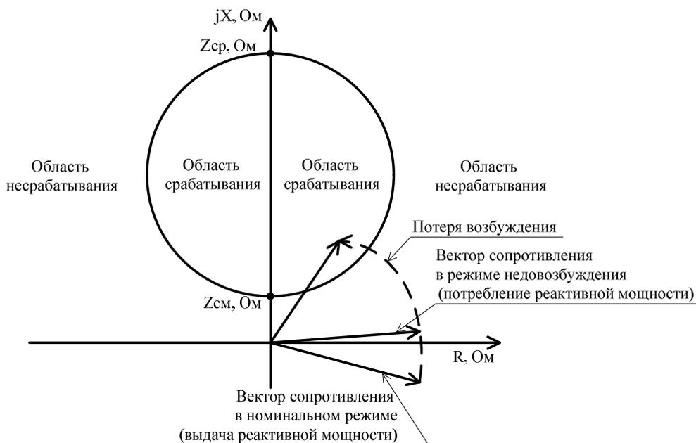
Рисунок 9 - Характеристика защиты от асинхронных режимов
