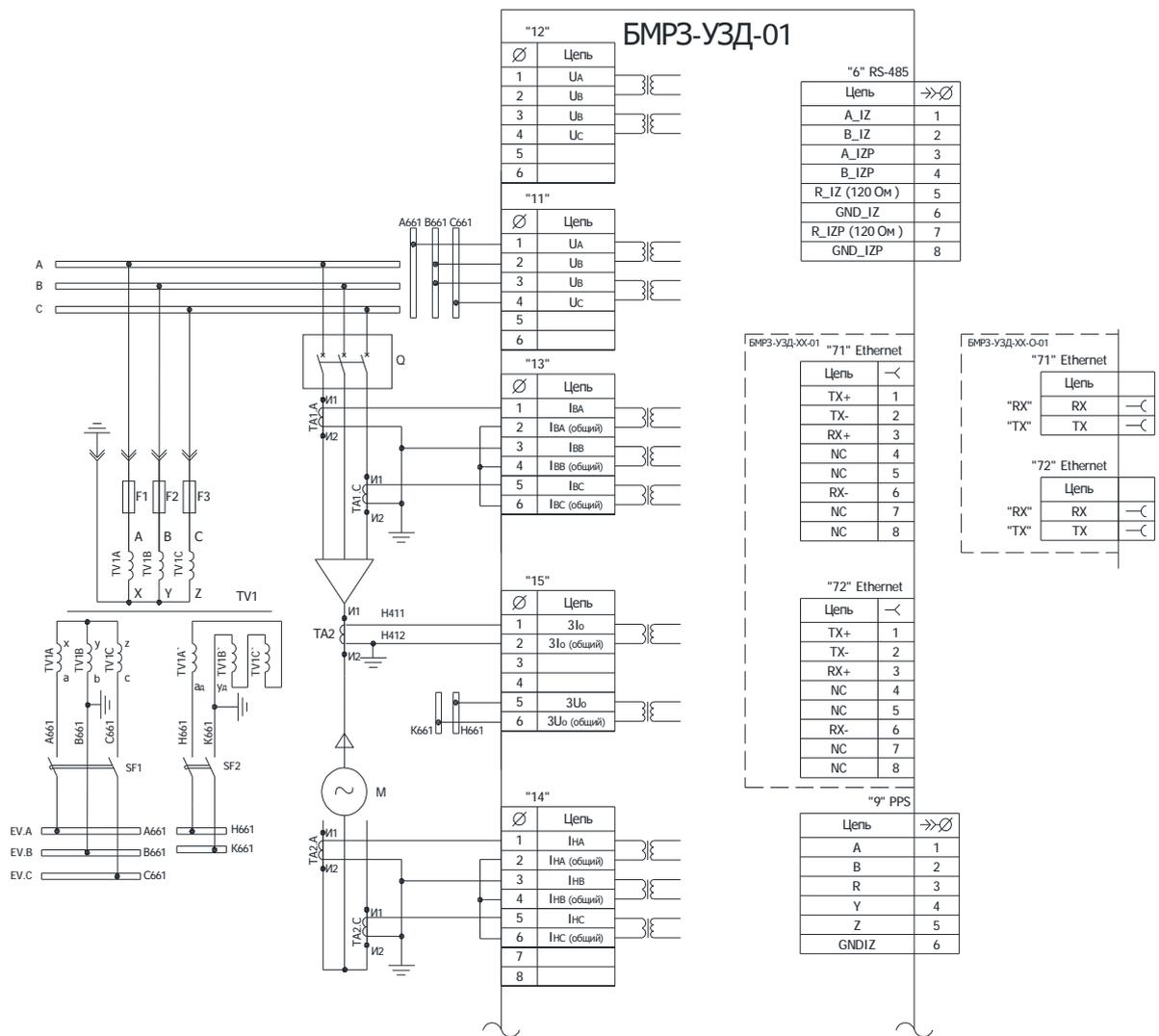
Рисунок А.1 (лист 2 из 2) - Схема электрическая подключения
