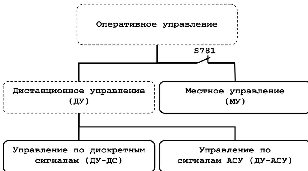
Рисунок 11 - Структурная схема организации режимов управления
