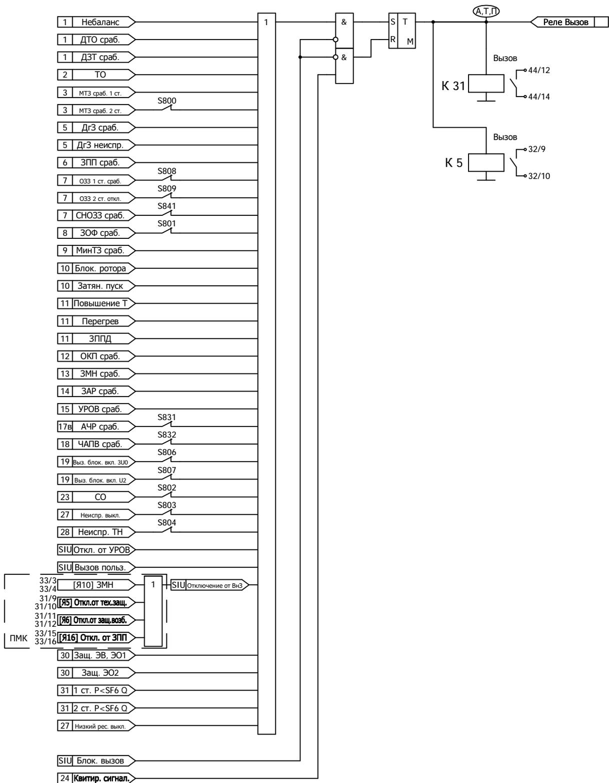
Рисунок Б.26 - Функциональная схема алгоритма вызывной сигнализации
