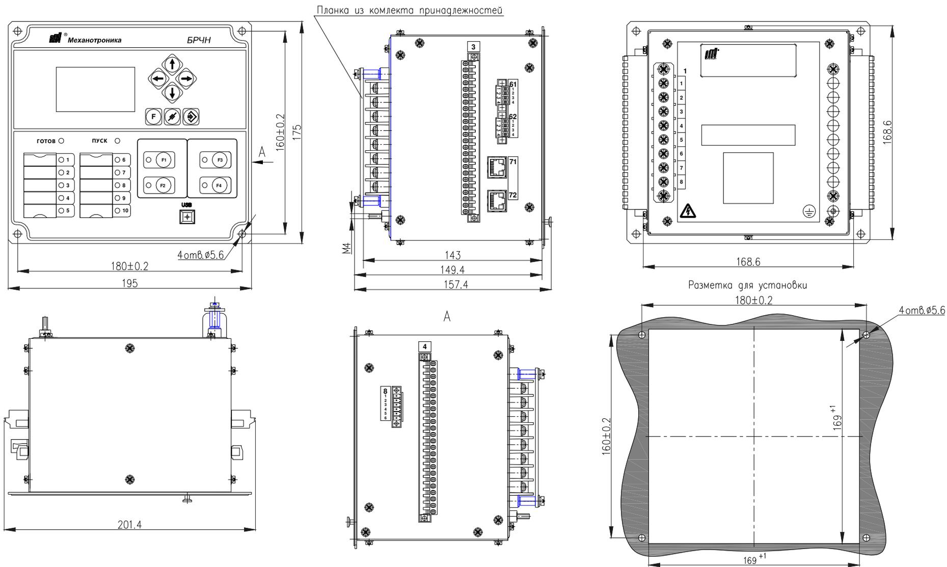
Рисунок 3 - Габаритные и установочные размеры, внешний вид блока
