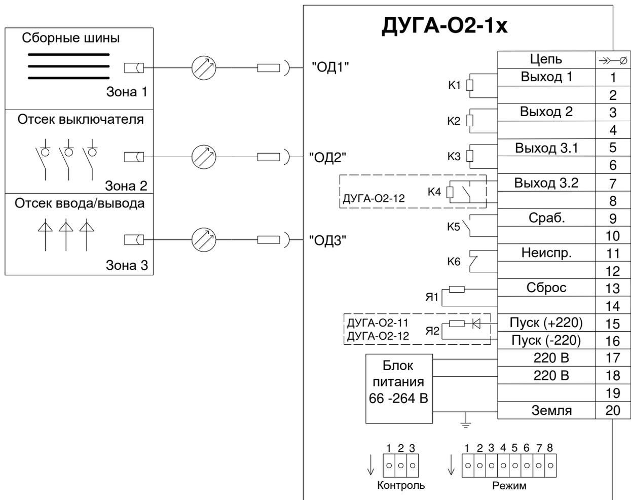
Рисунок 4 – Схема электрическая подключения без ЦОВ
