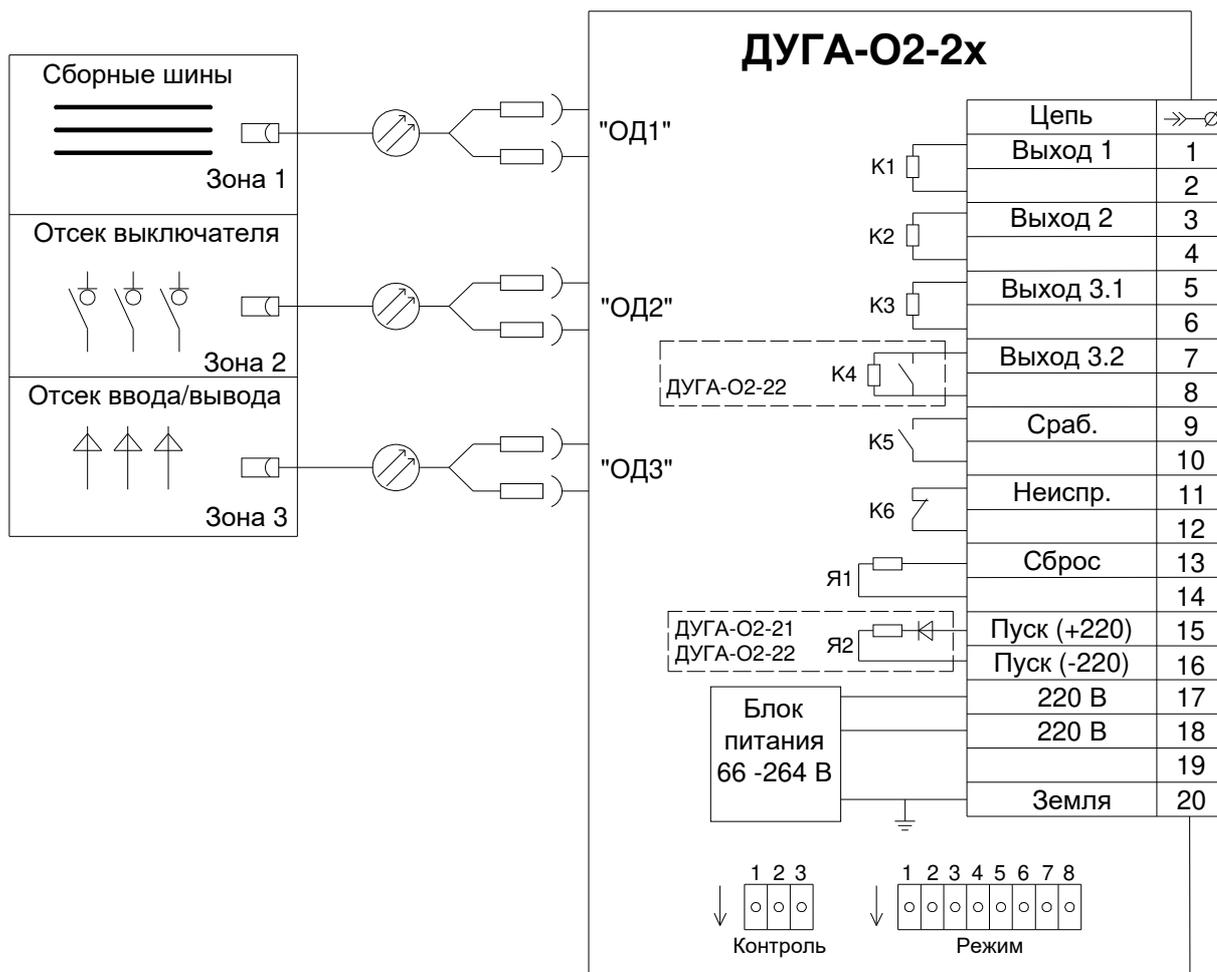
Рисунок 3 – Схема электрическая подключения с ЦОВ
