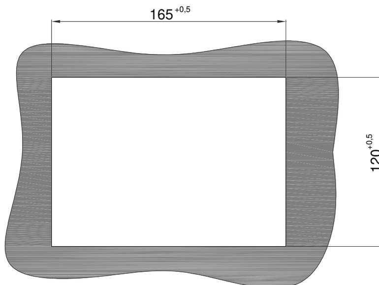
Рисунок 2 – Разметка для крепления регистратора
