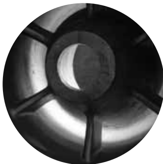
Вид на внутренний корпус и ребра через необработанную отливку
