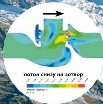
Обычный седельный клапан Разновекторность траекторий потока снижает рабочие характеристики трима и приводит к разбалансировке усилий в нем.
