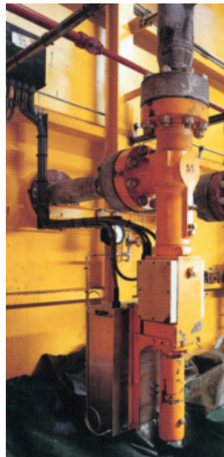
Дроссель добычи газа по принципу "нулевого потока", Северное море
