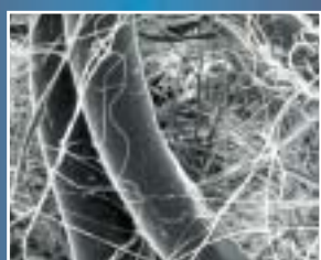
Зона окончательной фильтрации: Сверхтонкие волокна переплетены с волокнами CoLD
