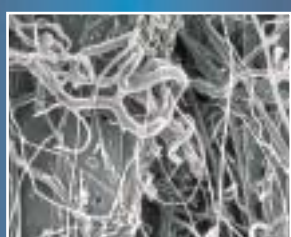
Промежуточные зоны предварительной фильтрации с волокнами CoLD
