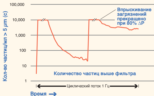
Рисунок 10: Воздействие циклического потока и длительного засорения на способность фильтра очистить систему.
