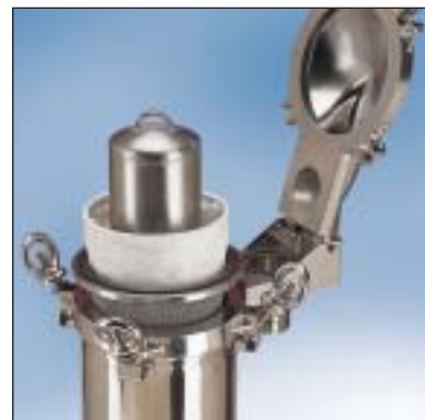
ПОПЛАВОК ИЗ НЕРЖАВЕЮЩЕЙ СТАЛИ Уменьшает объем свободного пространства внутри фильтрующего мешка
