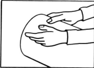
2. Проверьте, чтобы труба имела прямой разрез, закругленную внешнюю кромку под углом 15°. Нанесите смазочный материал марки Дука для уплотнительных колец только на раструбный конец трубы.
