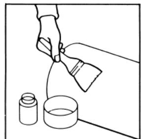
4. С помощью таблицы на рисунке 16 определите соответствующее клеящее средство марки Дука. В продольном направлении нанесите клей на поверхность трубы.
