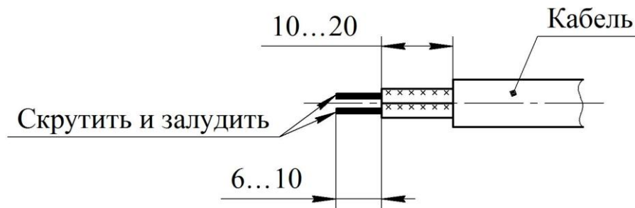
Рисунок 6 – Разделка кабеля
