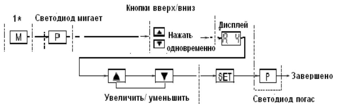
Рисунок Ж.5 - Алгоритм установки времени усреднения результата измерения (цифрового фильтра) для модели DT NDV
