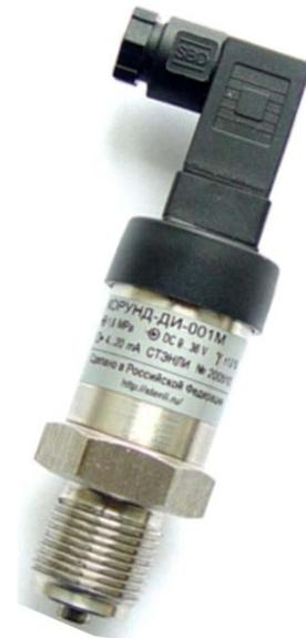
Датчик абсолютного давления КОРУНД-ДА-001М общепромышленного исполнения используют в работе микропроцессорную компенсацию погрешности во всем диапазоне рабочих температур от  $-40^{\circ}\text{C}$  до  $+80^{\circ}\text{C}$ . Все настроечные характеристики датчика абсолютного давления КОРУНД-ДА-001М фиксируются в энергонезависимой памяти. Имеются устройства подстройки нуля и диапазона.
