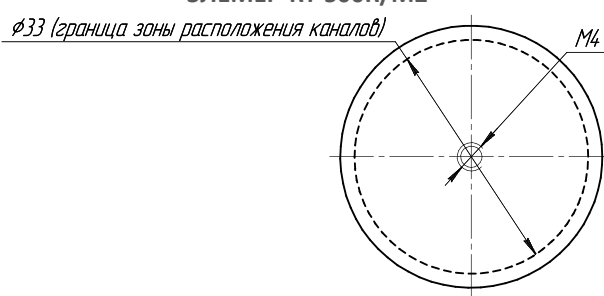
Нестандартный набор каналов в блоке сравнения ЭЛЕМЕР-КТ-500К/М2
