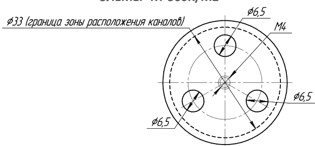
Стандартный набор каналов в блоке сравнения ЭЛЕМЕР-КТ-500К/М2
