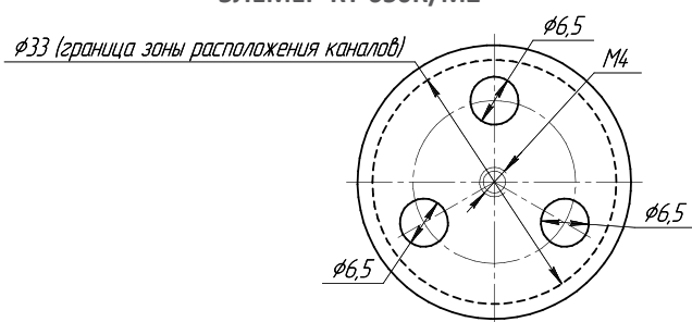
Стандартный набор каналов в блоке сравнения ЭЛЕМЕР-КТ-650К/М2
