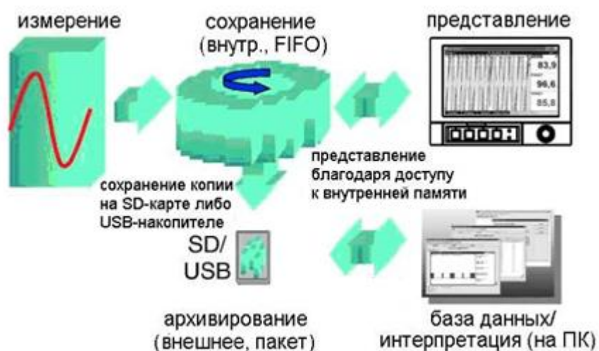
Рисунок 2.17 – Схематическое представление сохранения результатов измерения
