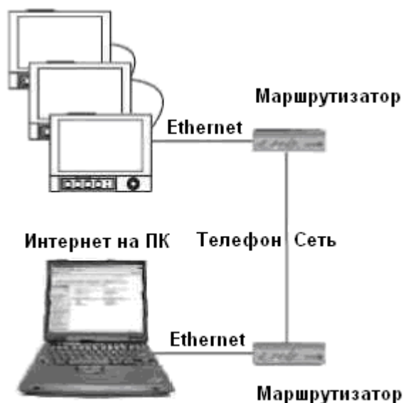
Рисунок 2.11 – Пример организации удаленного контроля с помощью веб-браузера
