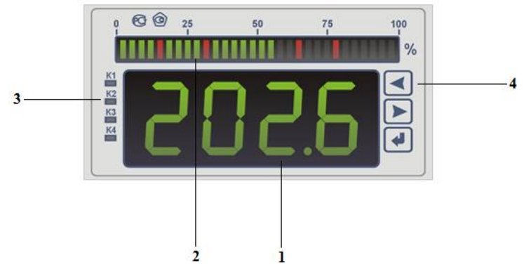
Рисунок 2.2 – Передняя панель ИРТ 5922-МВ
