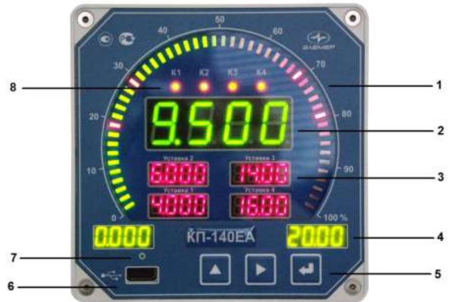
Рисунок 2.4 – Передняя панель КП-140Е
