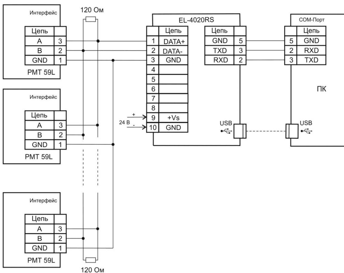
PMT 59L,... - измерительные приборы с интерфейсом RS-485.
