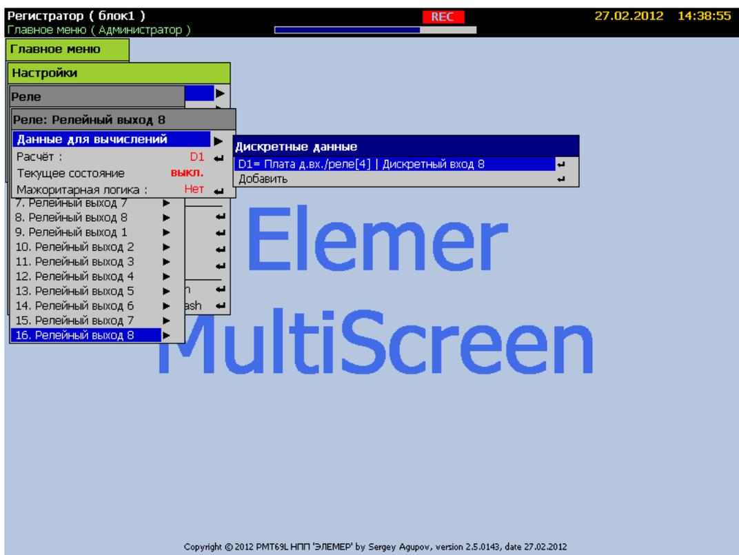
Каждое реле связано с соответствующим дискретным входом.
