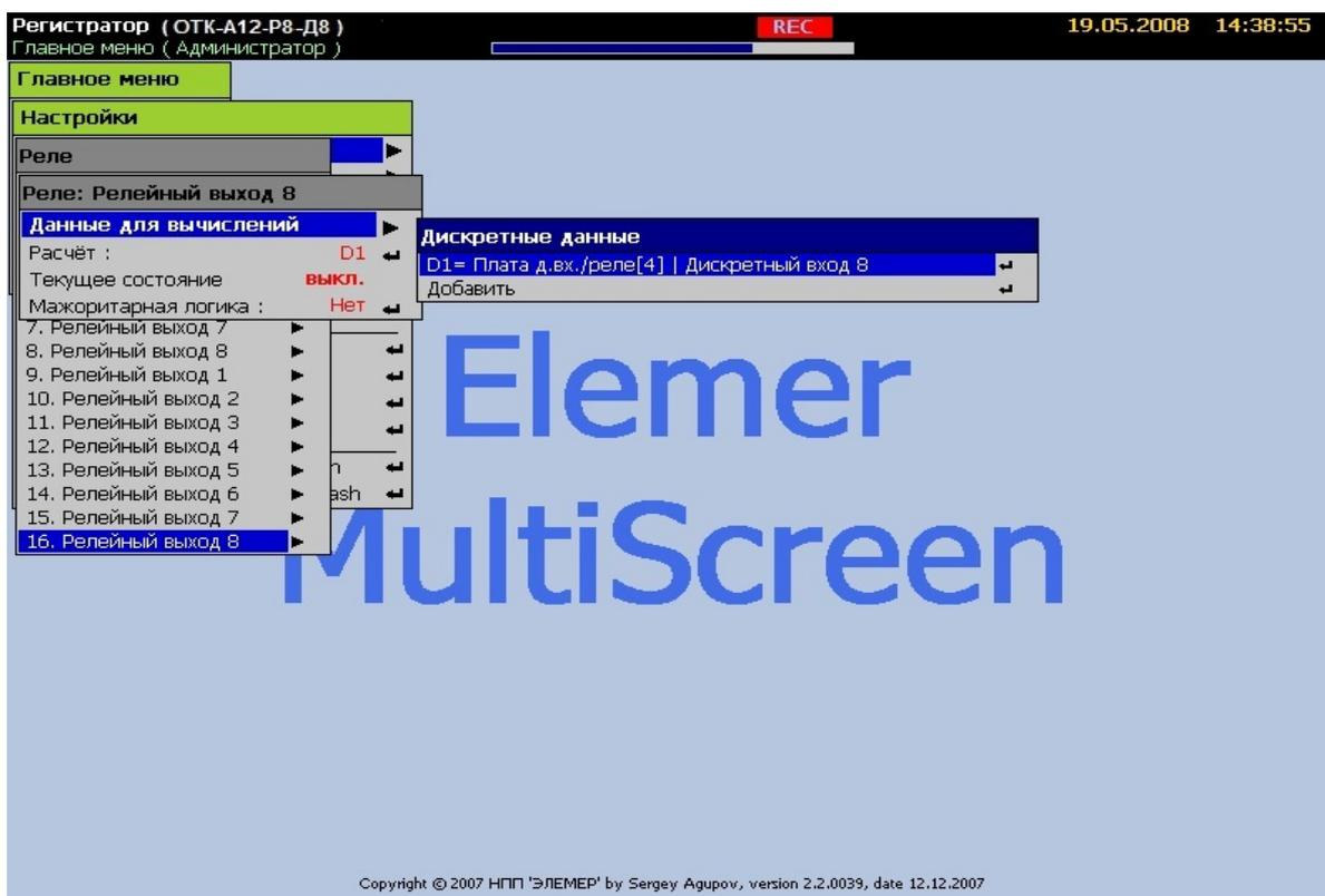
Каждое реле связано с соответствующим дискретным входом.
