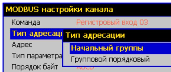
Если все каналы в списке устройства имеют тип адресации «Начальный группы», то посылается отдельная посылка для каждого из каналов для получения или записи значений по интерфейсу. Если количество каналов устройства достаточно большое, то таким же большим будет и количество посылок по интерфейсу, что скажется на скорости обмена и скорости обновления данных всех устройств, подключенных к внешнему COM-порту PMT 59M.
