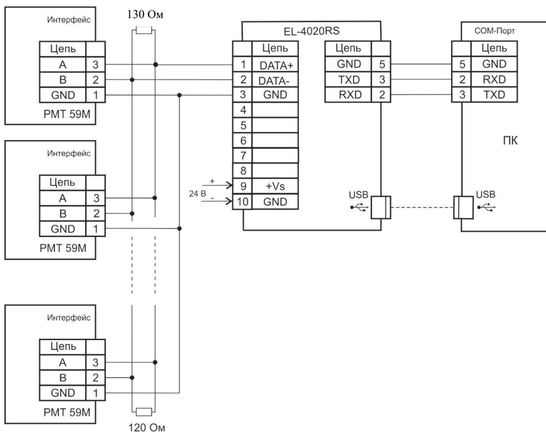
PMT 59M,...- измерительные приборы с интерфейсом RS-485.
