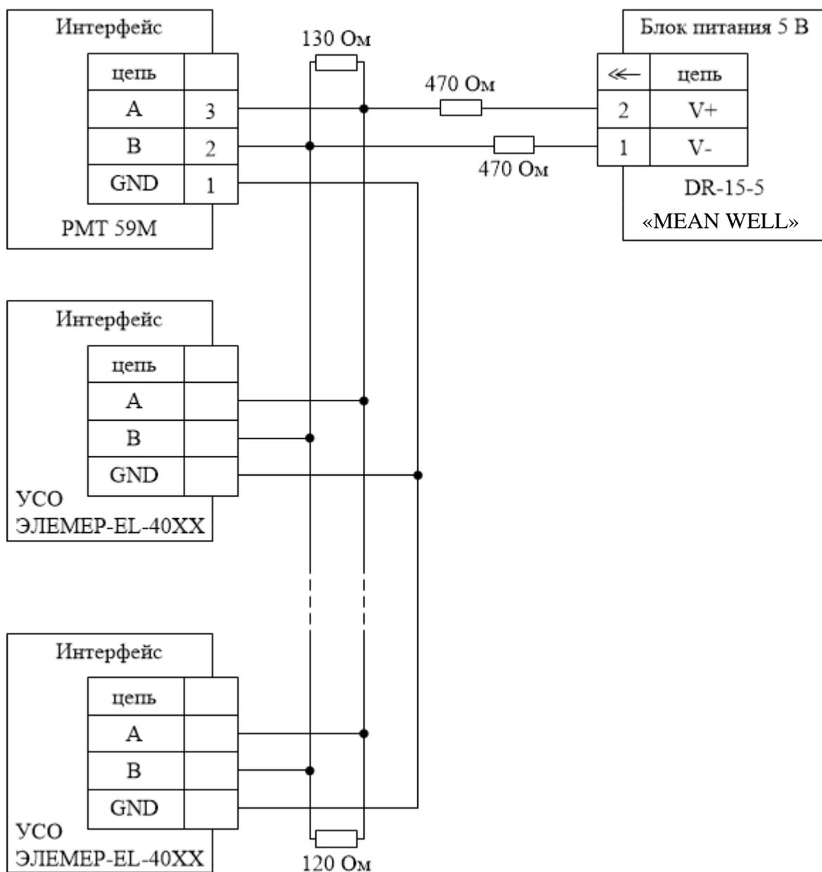
Количество подключенных YCO может быть увеличено при использовании репитеров линии RS-485. Суммарное количество встроенных и внешних устройств ввода-вывода должно быть не более 60.
