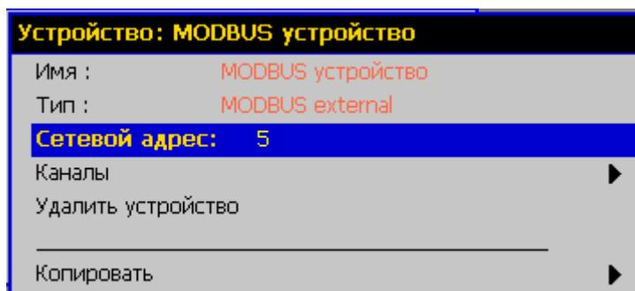
1. Имя – имя, которое будет присвоено в PMT 59M подключаемому устройству.
