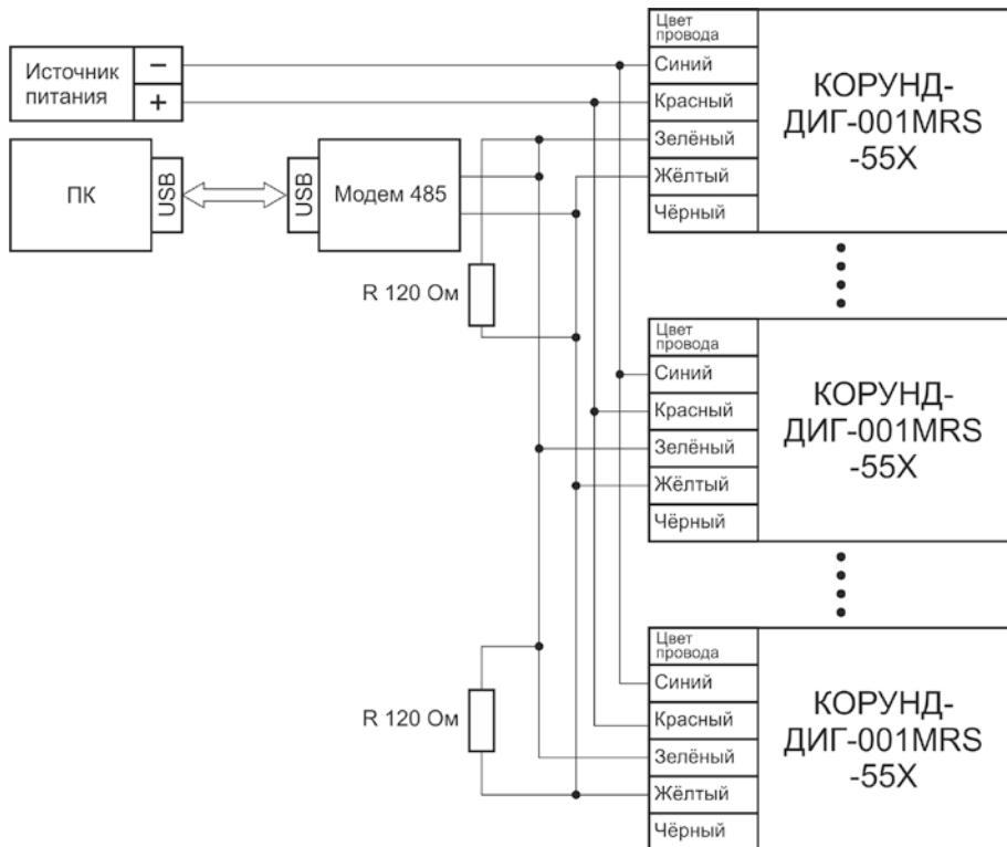
Рис.Б10. Схема соединения датчиков КОРУНД-ДИГ-001MRS-55Х с выходным сигналом RS-485 Modbus RTU в групповом режиме
