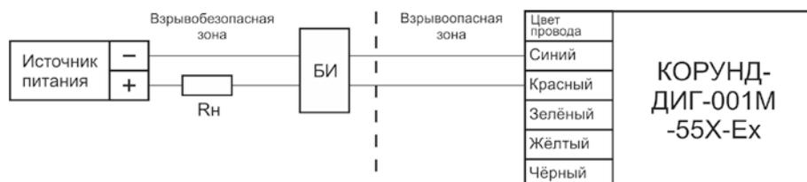
Рис.Б5. Схема соединений датчиков КОРУНД искробезопасного исполнения с внешним барьером искрозащиты (БИ).
