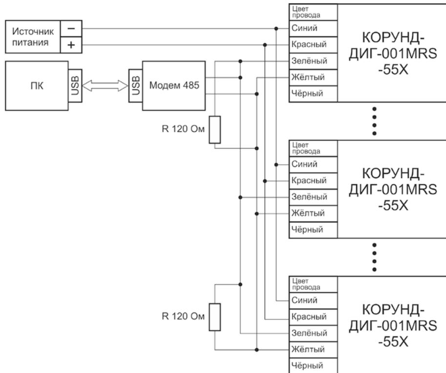
Рис.Б10. Схема соединения датчиков КОРУНД-ДИГ-001MRS-55X с выходным сигналом RS-485 Modbus RTU в групповом режиме
