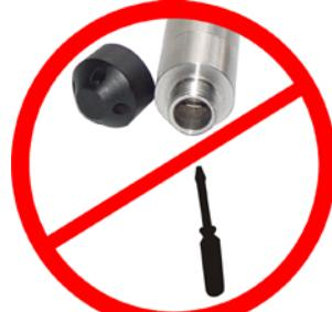
**Не пытайтесь чистить мембрану механическим воздействием твердыми предметами!**
