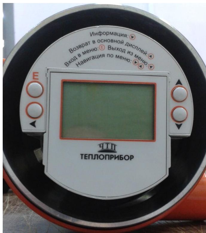
Рисунок 5 - Блок электроники с установленным дисплеем.
