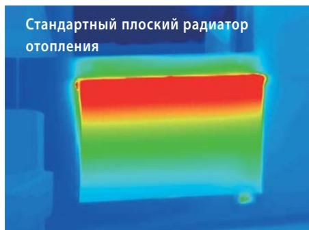
На термограммах хорошо видно, что последовательная обвязка по теплоносителю позволяет добиться более высокой средней температуры поверхности передней панели и, тем самым, способствует повышению интенсивности излучения до 100 %. Для Ваших клиентов это означает оптимальный температурный комфорт в каждой рабочей точке.
