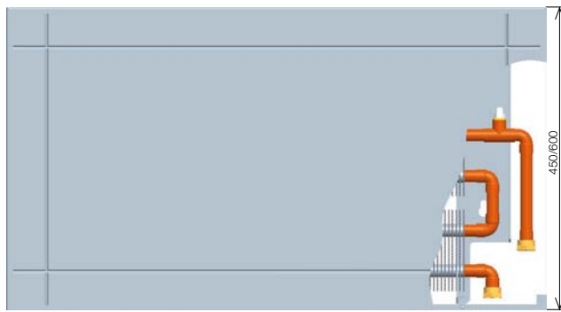
KORAWALL WK соединение снизу глубина 6 см и 12 см
