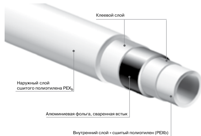
Рисунок 1. Структура трубы PE-Xb/Al/PE-Xb
