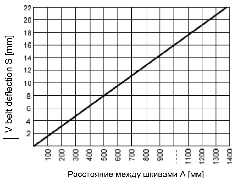
Рис. 25. Прогиб клиновидного ремня в зависимости от расстояния между шкивами
