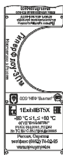
Рисунок Е.1 – Чертеж средств взрывозащиты блока электронного БЭ-020
