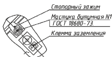
Рисунок Е.1 – Чертеж средств взрывозащиты блока электронного БЭ-020
