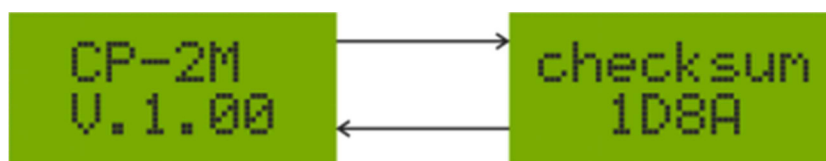
Рисунок 9. Состояние индикатора при выводе версии и контрольной суммы ПО.
