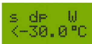
Рисунок 14. Состояние индикатора, когда измеренная dpW находится вне диапазона.
