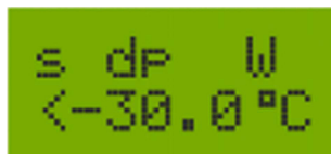
Рисунок 11. Состояние индикатора, когда измеренная dpW находится вне диапазона.
