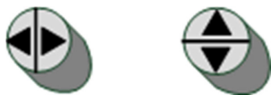
Рисунок 6. Ориентация магнитного ключа относительно индикатора прибора при работе с МК.
