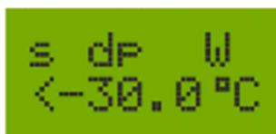
Рисунок 14. Состояние индикатора, когда измеренная dpW находится вне диапазона.
