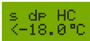
Рисунок 15. Состояние индикатора, когда dpW выше dpHC.
