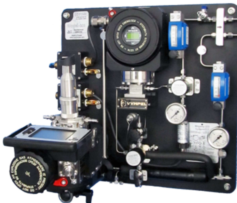
Рисунок П.1 — СПГ «Model-003» с анализатором «Hygrovision-BL»
