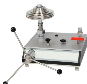
Грузопоршневой манометр высокого давления,
