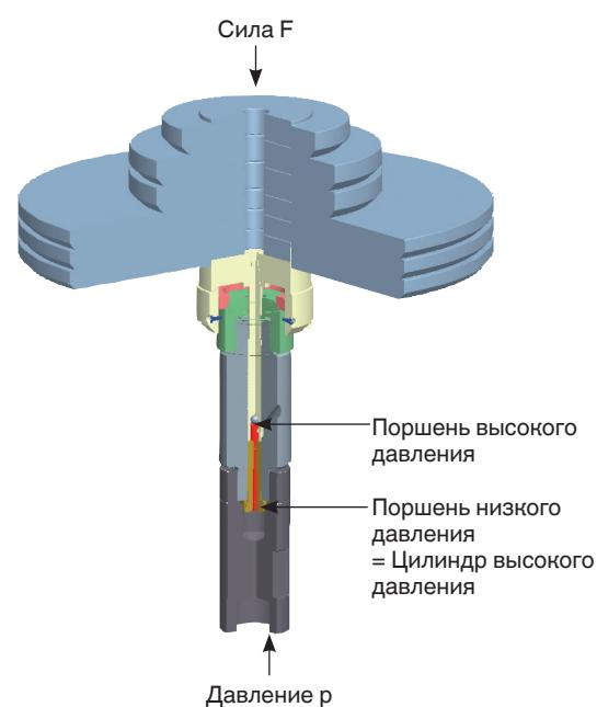
Двухдиапазонный узел поршень/цилиндр
