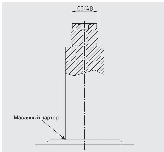
**Соединение для тестируемого прибора**
