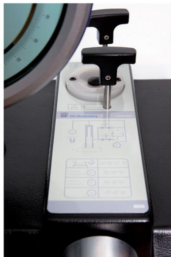
Схема управления прессовой части прибора CPB3800HP
