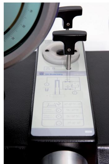
Схема управления прессовой части прибора
