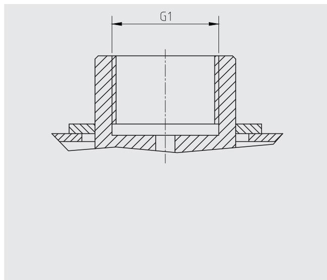
Соединение для тестируемого прибора
