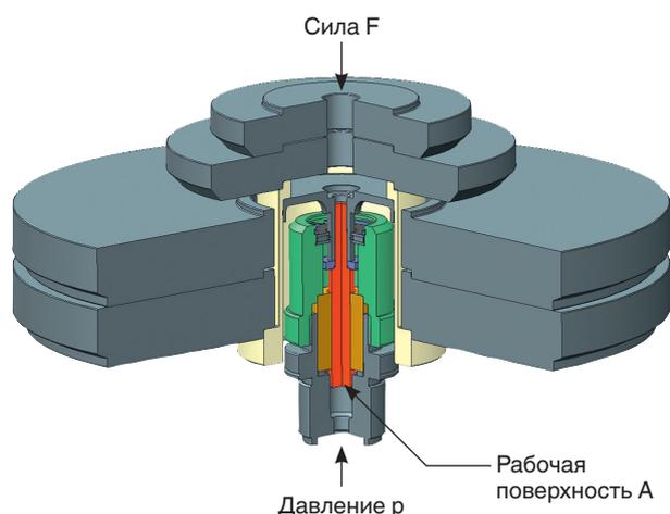
Узел поршень/цилиндр модели CPS3500
