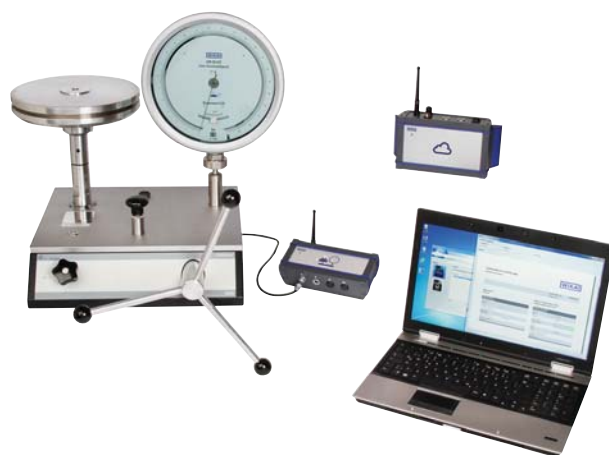
Модели CPU6000-W, CPU6000-S, CPB5800 и ПК с программным обеспечением WIKA-Cal
