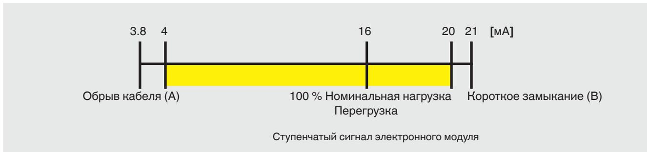
При фиксированном уровне сигнала, например, 4 мА, тестовый цикл может запускаться при любом рабочем состоянии путем активации реле.
